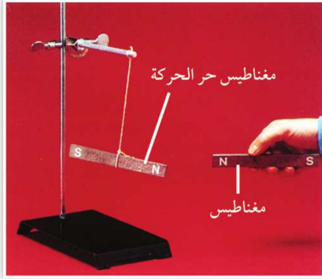
شكل (٢١): الأقطاب المتشابهة تتنافر، وغير المتشابهة تتجاذب.
